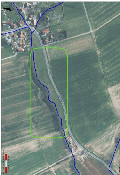
Abbildung 3: Unterlauf der Bermbach unterhalb der Ortschaft Bermbach – Querschnittsreduzierung durch Bewuchs
